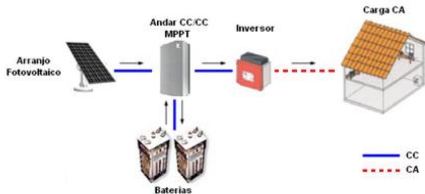
Figura 2.4 - Sistema fotovoltaico isolado com armazenamento
