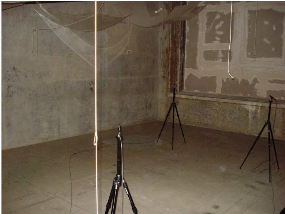
Fig. A.2 – Disposição dos microfones na câmara recetora R1
