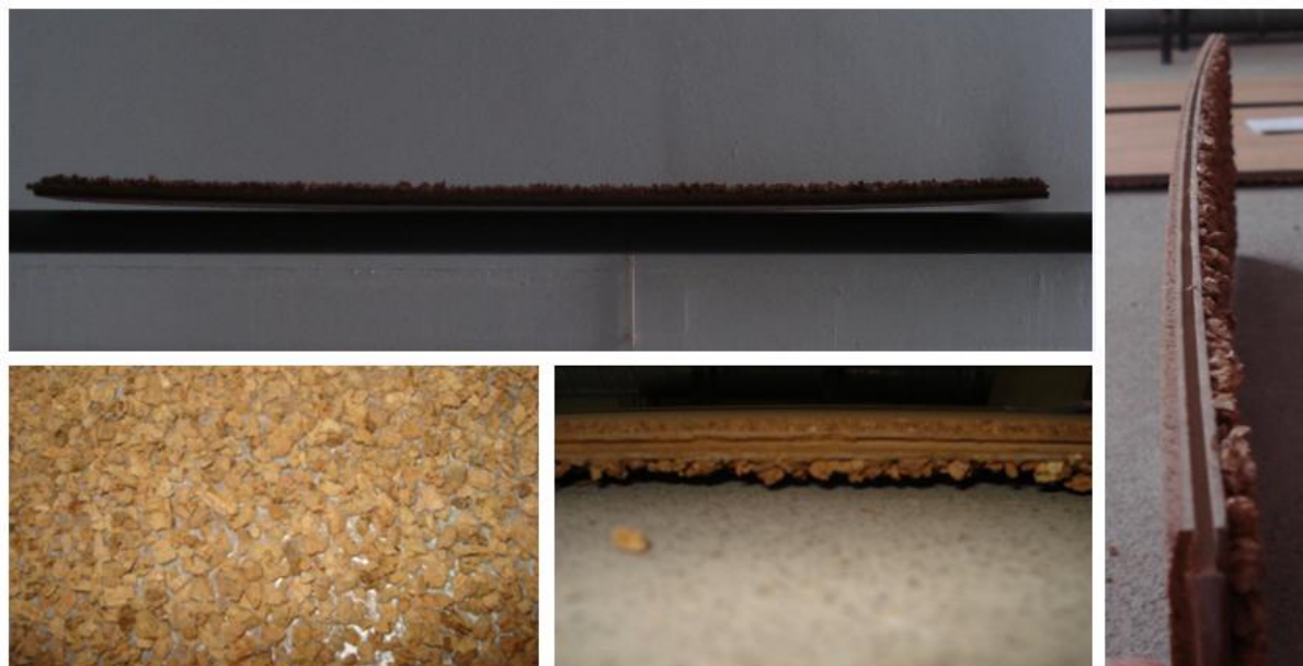
Fig. 7.4 – Fotos do estado final do pavimento Z após ter ficado 15 dias sobre o piso plano da zona de circulação do laboratório de Acústica
