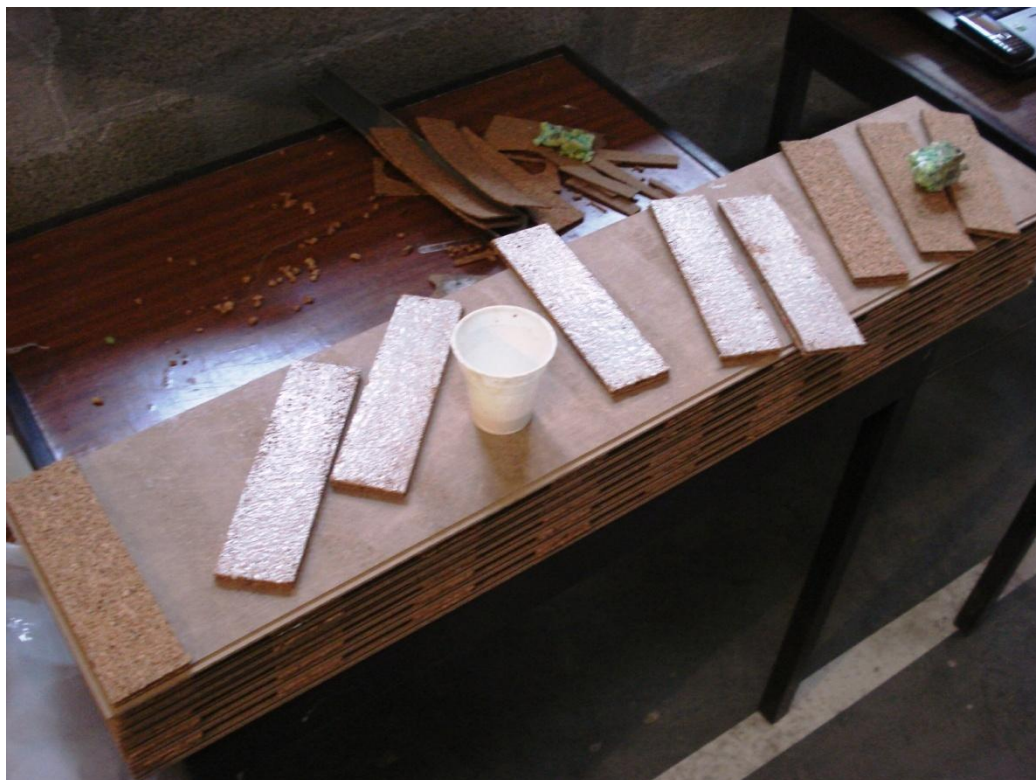
Fig. A.3 – Colagem das tiras de cortiça no pavimento U da “Experiencia 1 – Tiras e amortecedores”
