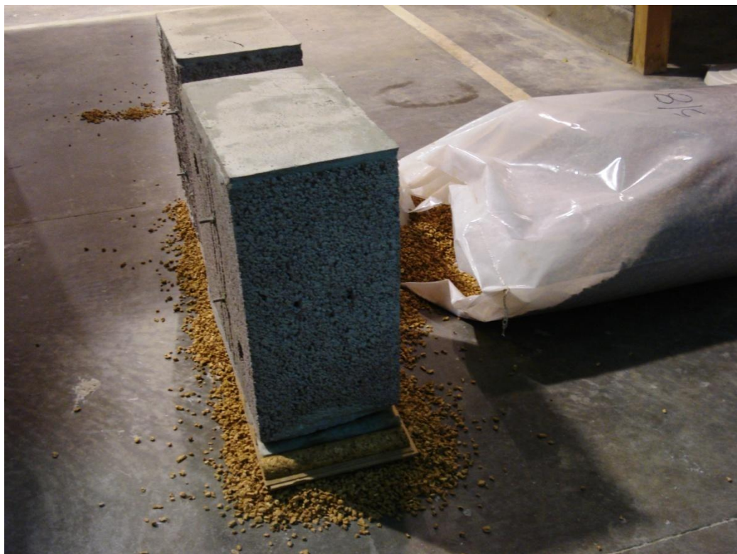
Fig. A.7 – Método usado na prensagem do granulado ao elemento resistente, para dar origem ao pavimento Z
