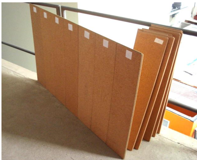
Fig. 6.1 – Pranchas e pavimento antes da montagem (atrás) e depois da montagem (à frente) pronto a colocar sobre a laje laboratorial para ensaio
