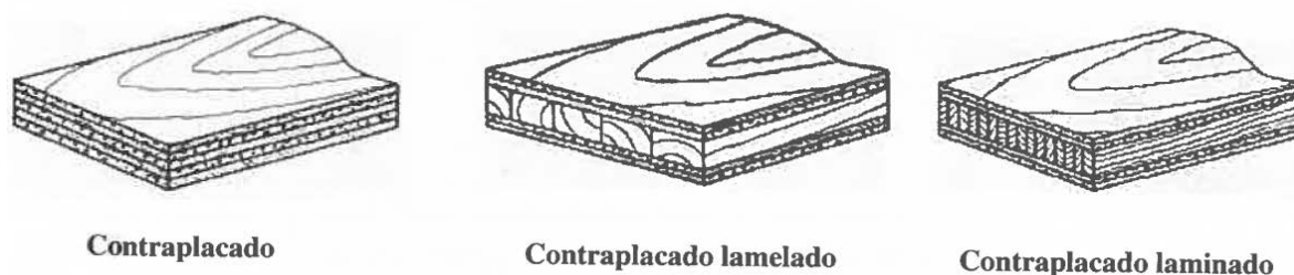
Fig. 5.2 – Tipos de contraplacado em função da sua composição [59]
