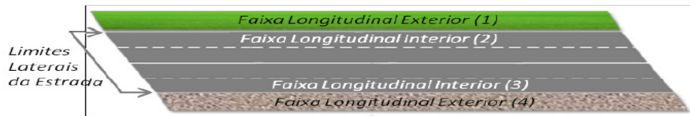
Figura 5.11 - Faixas longitudinais para o cálculo do SR [3]
