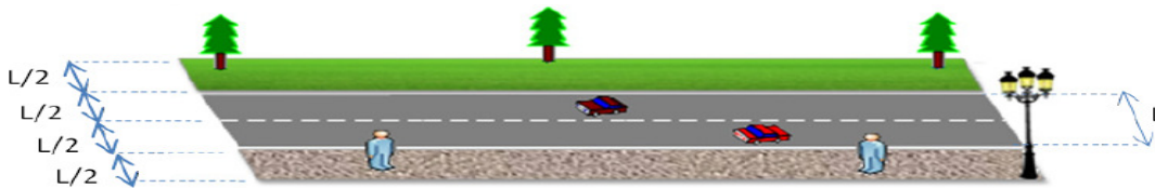
Figura 5.13 - Esquematização para a situação em que o cálculo do SR é feito para metade da largura da estrada [3]
