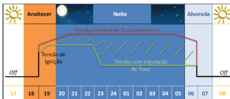
Figura 3.4 - Exemplo de funcionamento de um Regulador de Fluxo Luminoso ao longo do período noturno[24]
