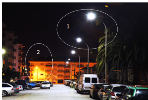
Figura 4.3 - Diferença do IRC da Lâmpada LED e Vapor de sódio alta pressão, 1 e 2 respetivamente[26]
