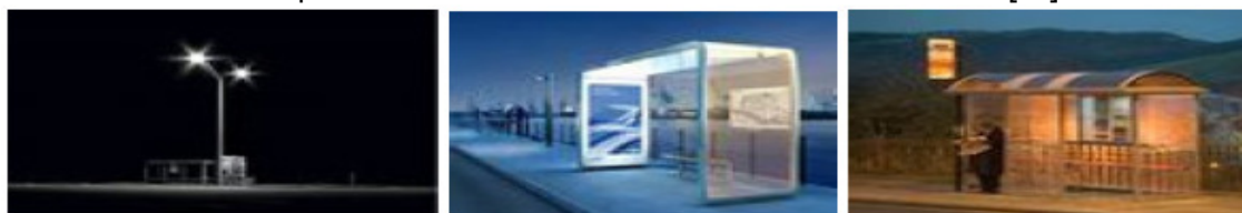
Figura 5.15 - Exemplificação de não uniformidade de iluminação (esquerda) e uniformidade da iluminação junto às paragens de autocarro (centro e direita)[29]
