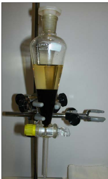
Figura 11. Ampola de decantação com separação de fases.
