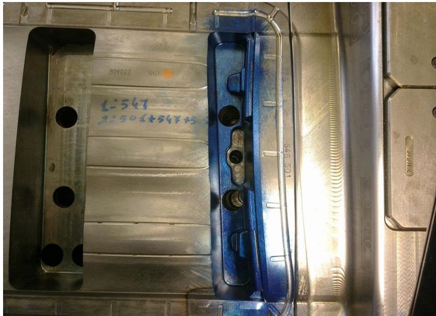
Figura 16 – Pintura da caixa com tinta de ajustamento (Imagem do Autor)
