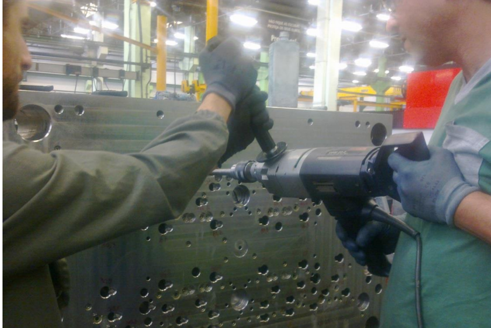
Figura 22 - Operários a mandrilar furos manualmente (Imagem do Autor)
