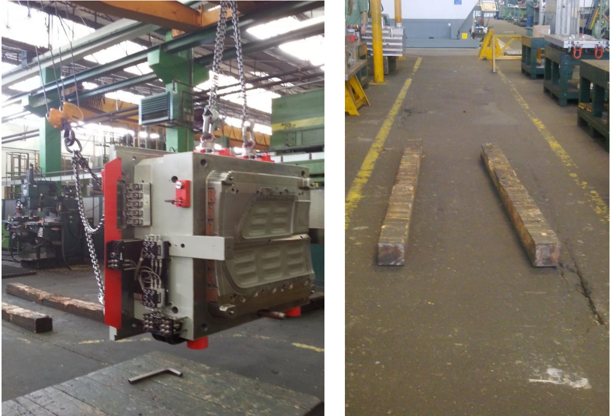
Figura 40 - Rotação de moldes com auxílio de troncos de madeira (Imagem do Autor)
