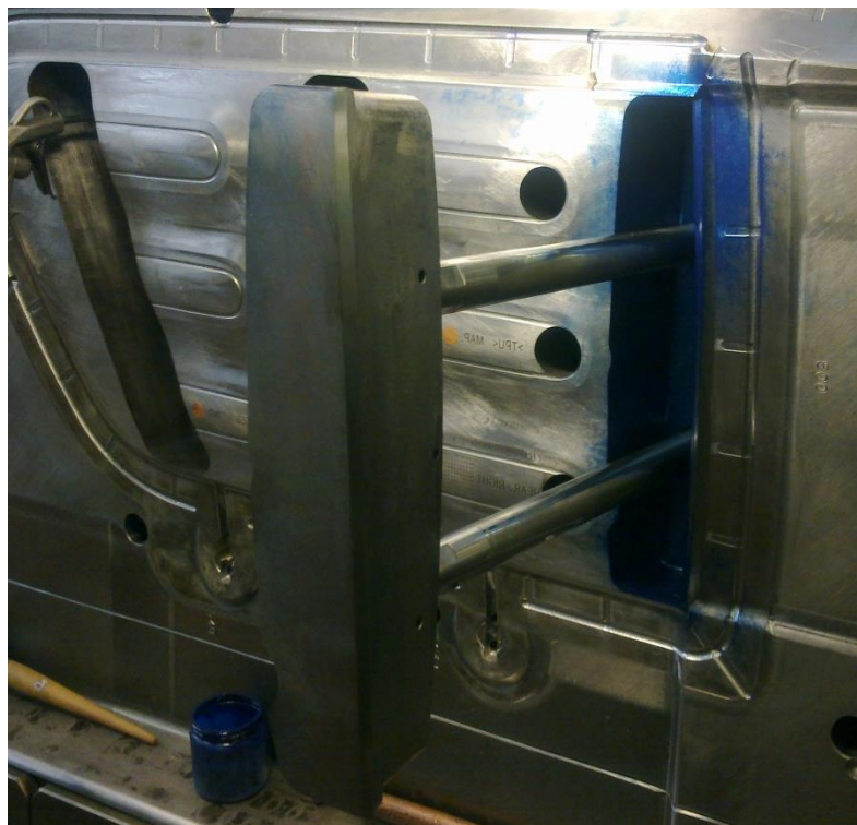
Figura 18 - Peça retirada da caixa por batimento (Imagem do Autor)
