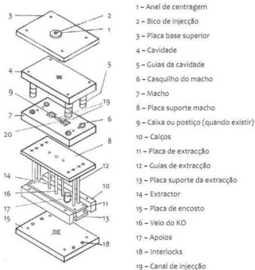
Figura 3 - Elementos principais de um molde (Reinert, 2004)
