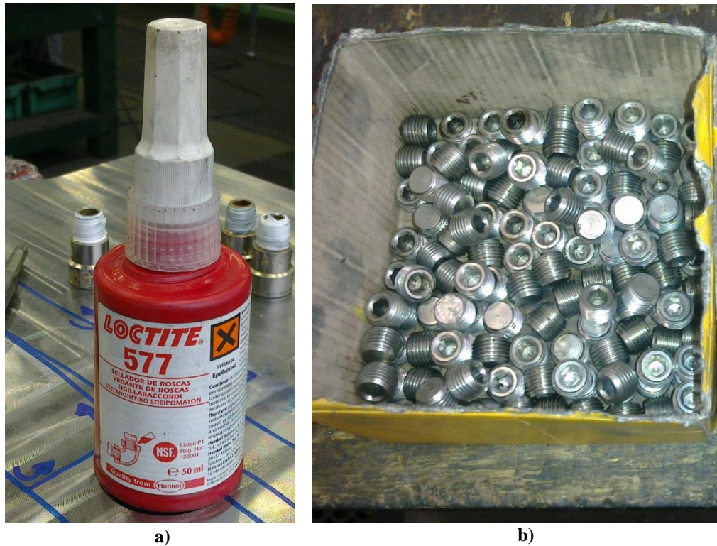
Figura 29 – Selante de roscas Loctite 577 (a) e bujões utilizados (b) (Imagem do Autor)
