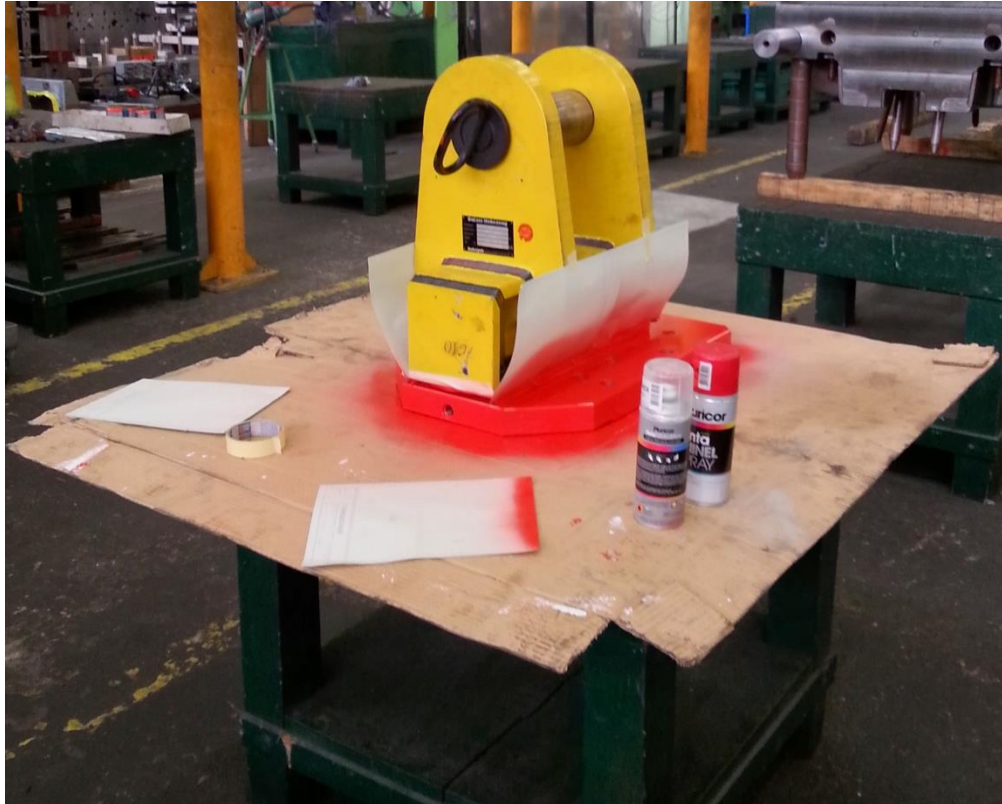
Figura 39 - Pintura de componentes a spray (Imagem do Autor)
