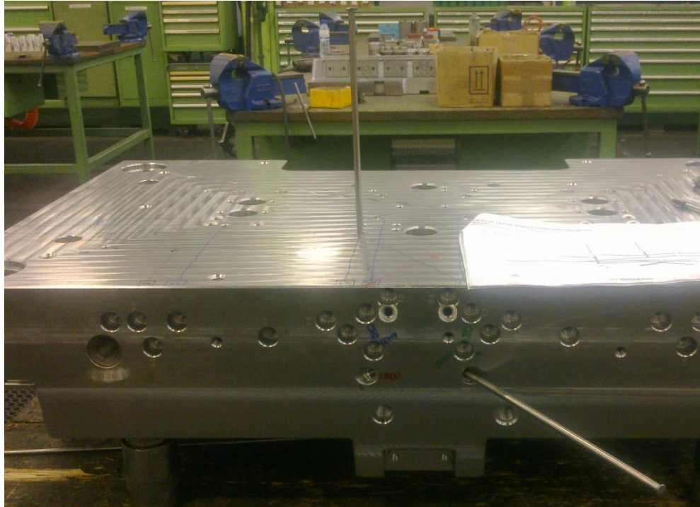
Figura 27 - Varões de aço inseridos nos furos do circuito de refrigeração (Imagem do Autor)
