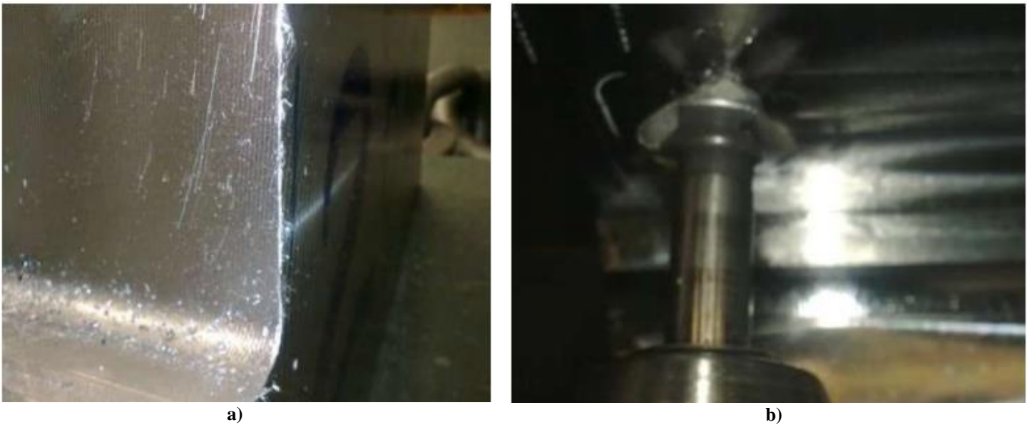
Figura 24 – Operações realizadas manualmente na bancada, (a) quebrar quinas (b) escarear furos (Imagem do Autor)
