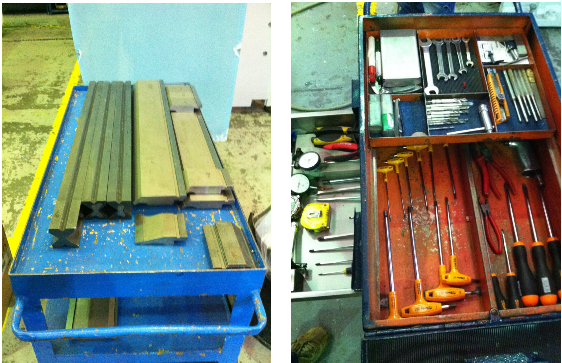
Figura 16 Aplicação dos 5S nos carros de ferramentas
