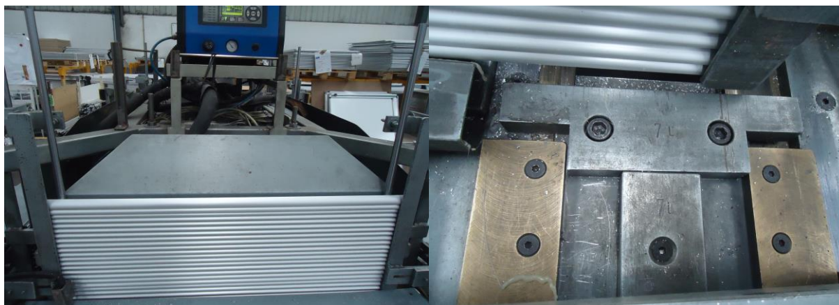
Ilustração 11 - Alimentador e empurrador de uma célula de trabalho de montagem do produto final.
