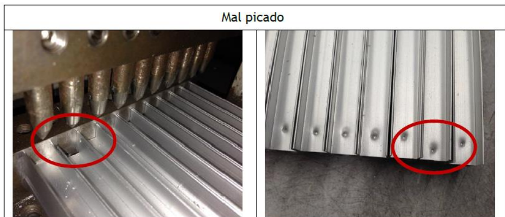
Ilustração 26 - Instrução de trabalho das máquinas de picagem.
