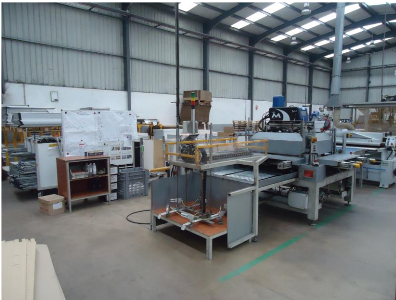
Ilustração 3 - Máquina 120x90 onde foi realizado o SMED . As máquinas 90x60 e 60x45 são idênticas.
