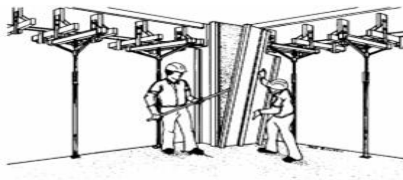
Fig. 3.57 – Retirada dos painéis laterais em pilares
