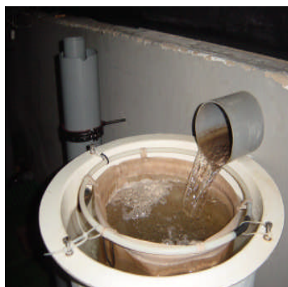
Figura 7: Sistema de recolha de ovos
