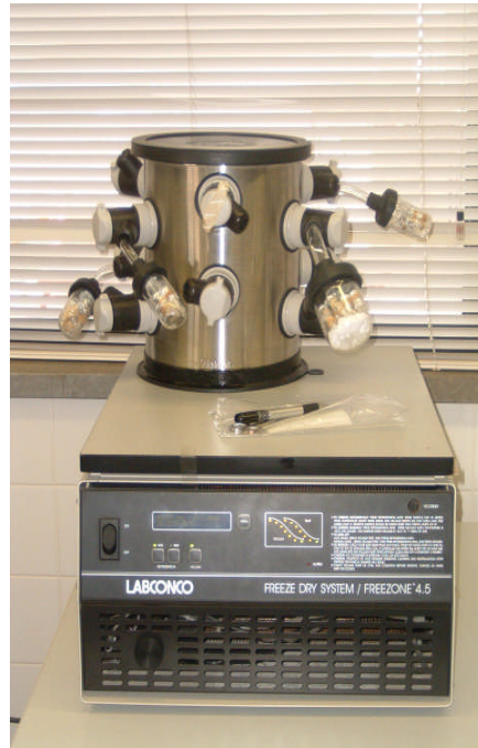
Figura 10: Aparelho para liofilizar as amostras de ovos para análise do perfil ac. Gordos.
