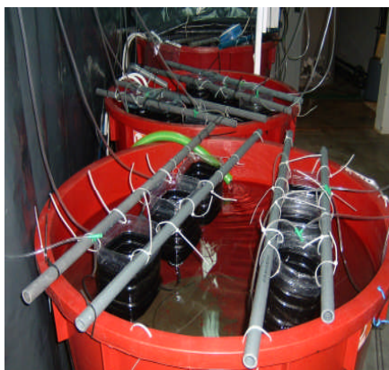
Figura 13: Tanques (jarros de 3 litros) de incubação em triplicado utilizados para determinação das taxas de eclosão e sobrevivência assim como para acompanhamento do desenvolvimento embrionário.
