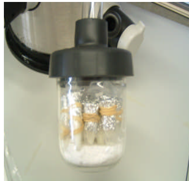
Figura 11: Aspecto do acondicionamento das amostras em processo de liofilização.
