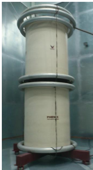
Figura 5.7 - Transformador existente no LAT
