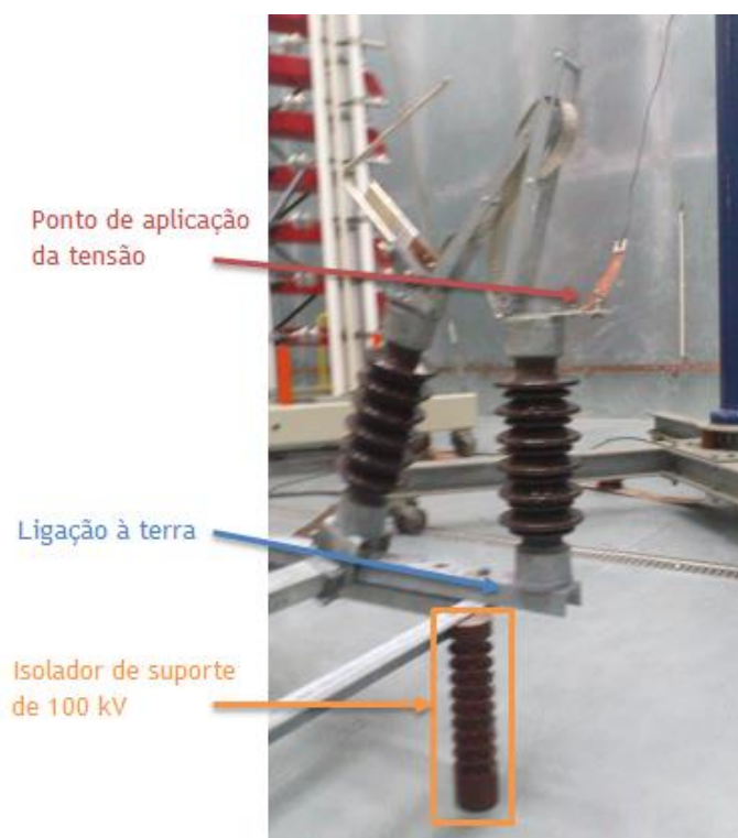
Figura 6.1 - Montagem para o ensaio fase-terra
