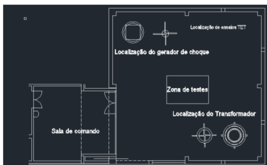
Figura 5.1 - Planta do LAT e disposição do equipamento
