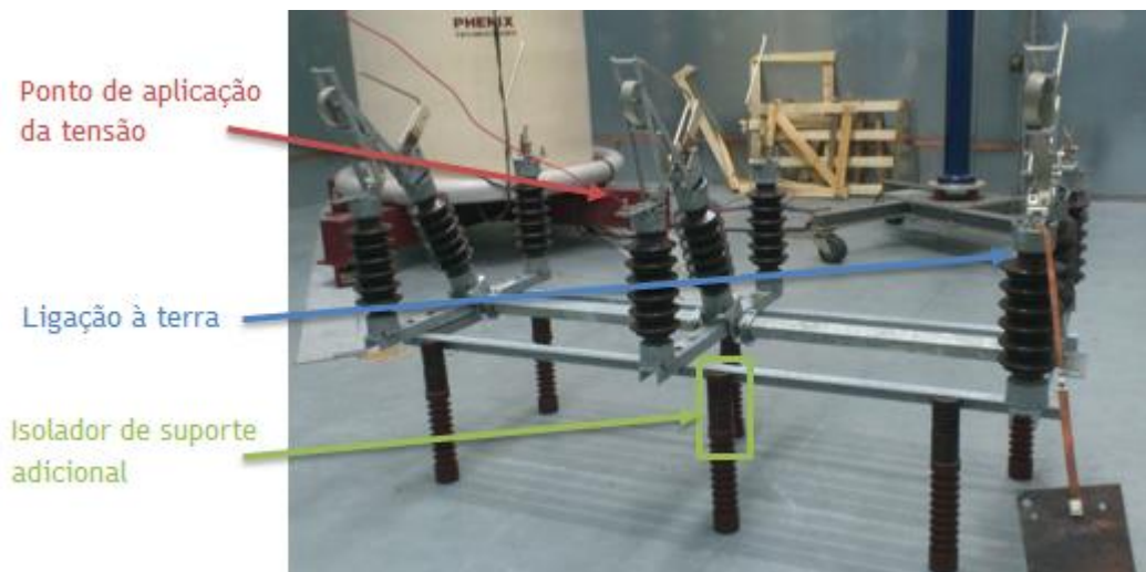
Figura 6.3 - Montagem para o ensaio entre pólos
