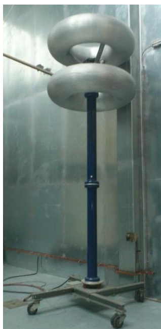
Figura 5.8 - Divisor de tensão do transformador
