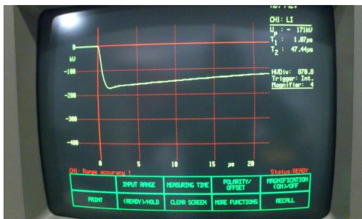
Figura 6.4 - Exemplo de uma onda completa retirado do ecrã do D.I.A.S.
