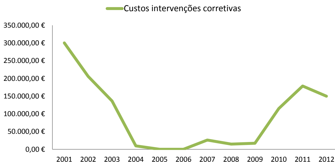
Figura 4.10 – Variação dos custos com intervenções corretivas/substituição de elementos de construção civil no período de 2001-2012.
