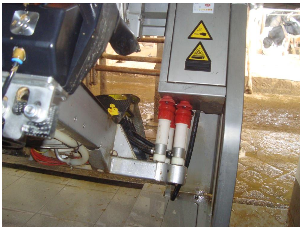
Figura 3 – Sistema de desinfecção das tetinas depois de ser ordenhada cada vaca.
