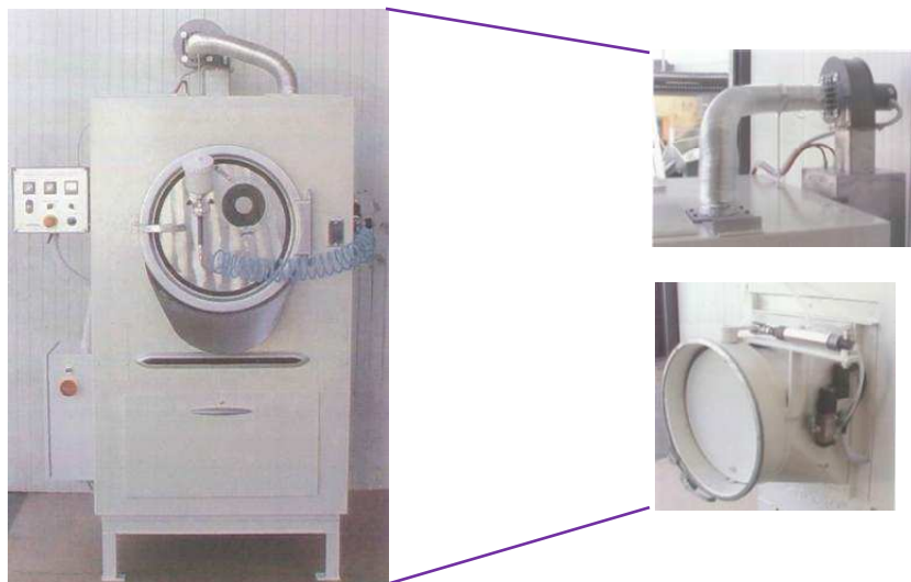
Figura 26 - Alterações efectuadas na máquina Passat industrial existente na fábrica.
