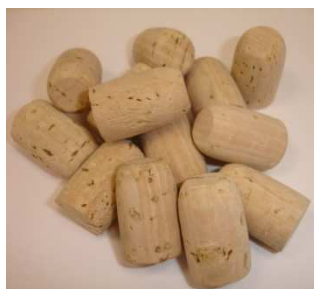
Figura 20 - Rolhas usadas para revestimento.
