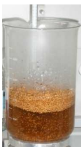
Figura 3 - Extracção sólido-líquido de compostos polifenólicos.
