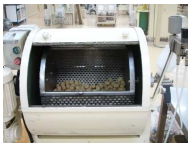
Figura 19 - Tambor semi-industrial devidamente alterado para revestimento de rolhas de cortiça.
