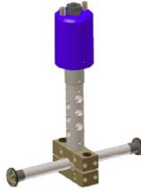
Figura 1 – Imagem ilustrativa do atomizador de partículas por ultra-sons
