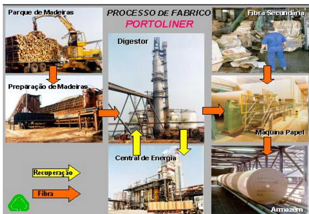
Figura 24 - Processo de fabrico de Portoliner. (fonte Portucel Viana)
