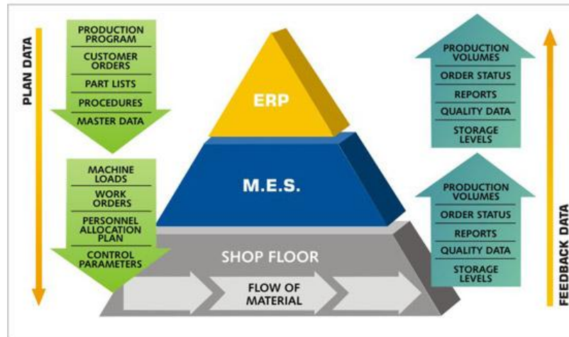
Ilustração 9 - Esquema da arquitectura dos sistemas de informação
