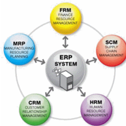
Ilustração 8 - Estrutura típica dos sistemas ERP
