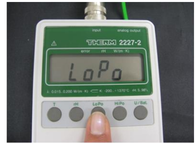
3º Pressionar o botão Low-Power-Key (LoPo) ou High-Power-Key (HiPo) de acordo com as expectativas do valor de condutividade térmica.
