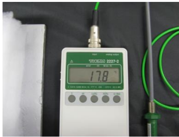
2º Esperar até que surja o valor da temperatura (°C) no visor.
