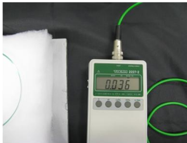
5º O final da medição é assinalada por um sinal sonoro; o valor da condutividade térmica ( W \cdot m^{-1} \cdot K^{-1} ) surge no ecrã.
