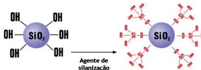
Figura 2 - Esquema representativo do processo de silanização (Adaptado de CabotCorporation, 2009)
