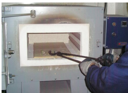
Fig. 31 – Mufla para aquecimento das amostras para estampagem
