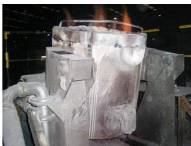
Fig. 18 – Forno de cadinho, aquecido a gás propano, de 700 kg de capacidade
