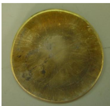
Fig. 33 – Amostra, após estampagem, da liga BASB13F, actualmente produzida na Alberto da Silva Barbosa & Filhos, L. da - boa plasticidade a quente
