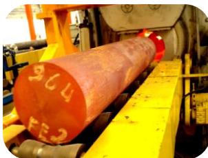
Figura 7 – Etapas da extrusão: aquecimento, extrusão e saída de perfil de latão para rolo.
