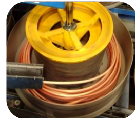
Figura 7 – Etapas da extrusão: aquecimento, extrusão e saída de perfil de latão para rolo.
