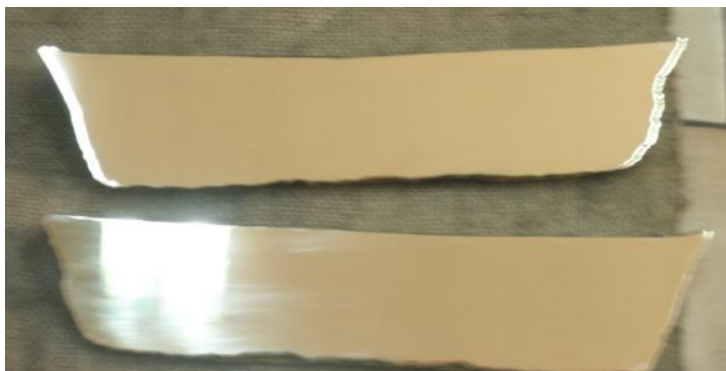
Fig. 47 – Amostras de lingote polidas, isentas de defeitos
