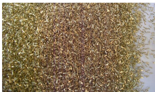
Fig. 29 – Limalha produzida na maquinação da liga BASB14G
