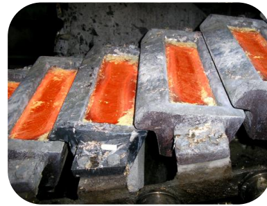
Fig. 6 – Vazamento para lingoteira
