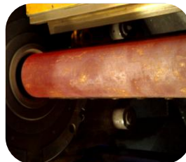
Figura 7 – Etapas da extrusão: aquecimento, extrusão e saída de perfil de latão para rolo.
