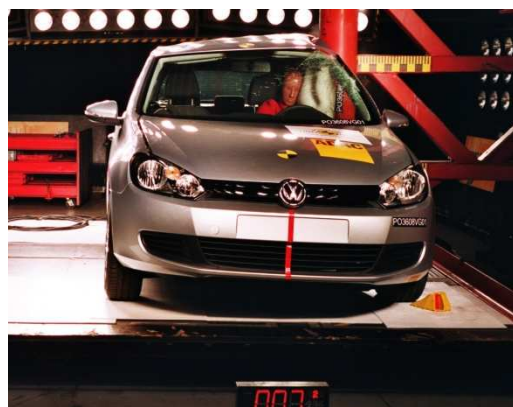
Figura 24 - Teste experimental contra poste (ou equiparado) (Euro NCAP, 2010).
