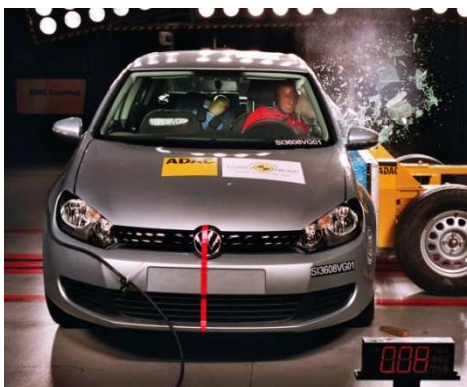
Figura 22 – Teste impacto lateral entre 2 veículos (Euro NCAP, 2010).
