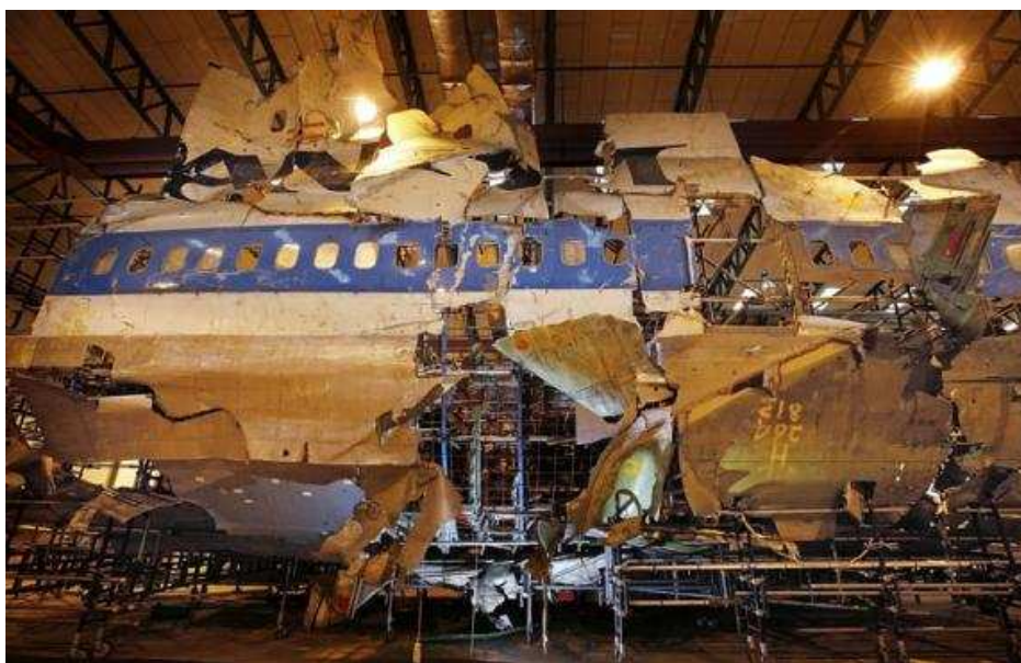
Figura 6 - Reconstrução do avião Boeing 747 - 121, da Pan Am ( Atentado de Lockerbie).
