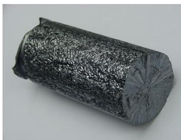
Figura 8 - Aspeto de um cilindro de silício policristalino [8].
