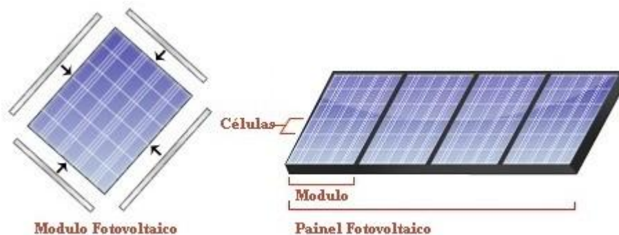
Figura 14 - Célula, módulo e painel fotovoltaico [19].
