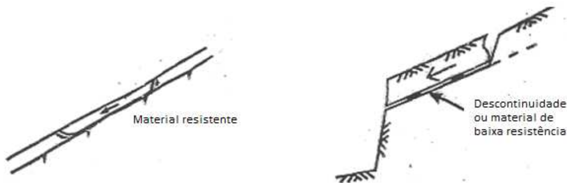
Figura 2.14 – Superfícies de rotura – escorregamento translacional (Gerscovich, 2010)
