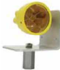
Figura 3.28 – Alvos de reflexão total utilizados para as leituras no baluarte (Cruz et al, 2008)
