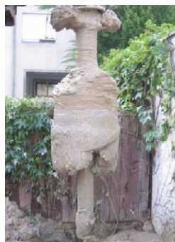
Figura 6.27 – Aspecto da ferramenta de corte após a extracção num solo argilosos – efeito “saca-rolhas” (Falk e Sigmud, 2009 – Sousa, 2009)
