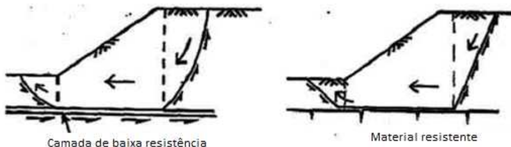
Figura 2.15 – Escorregamento misto – superfícies de rotura (Gerscovich, 2010)
