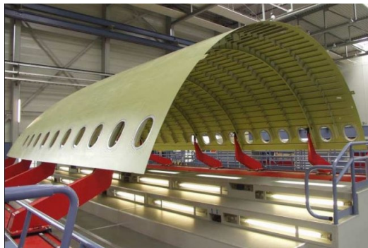
Figura 24 Construção da fuselagem do Airbus A380 em GLARE
