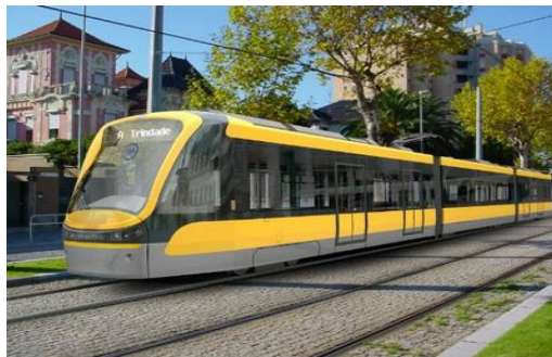
Figura 19 Painéis laterais do metro do Porto produzidos por RTM
