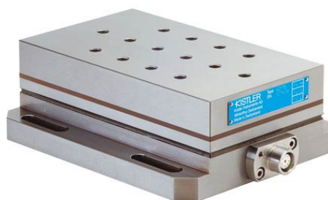
Figura 39 Dinamómetro KISTLER utilizado na monitorização das forças axiais
