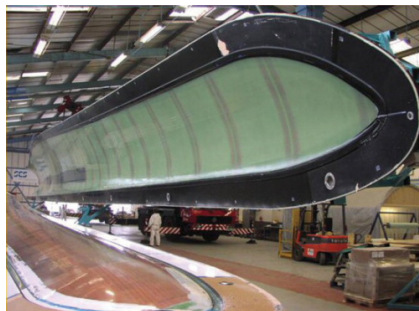
Figura 23 Processo de fabrico para hélices de torres eólicas por moldação por transferência por resina
