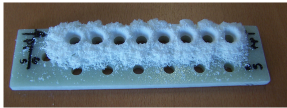
Figura 52 Placa em GFRP após furação
