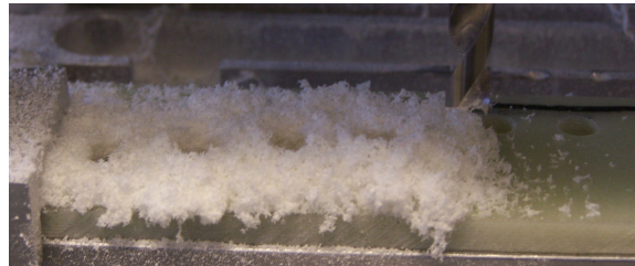
Figura 53 Broca brad durante o processo de furação
