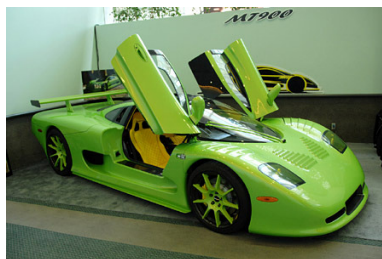
Figura 27 Super-desportivo Mosler MT900 com estrutura monocoque integral em CFRP.
