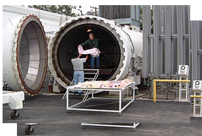
Figura 15 Autoclave de grandes dimensões para cura de componentes em FRP.
