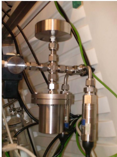
Figura 9: Equipamento para a realização do método de medição da permeabilidade disponível na FEUP, “time - lag”.
