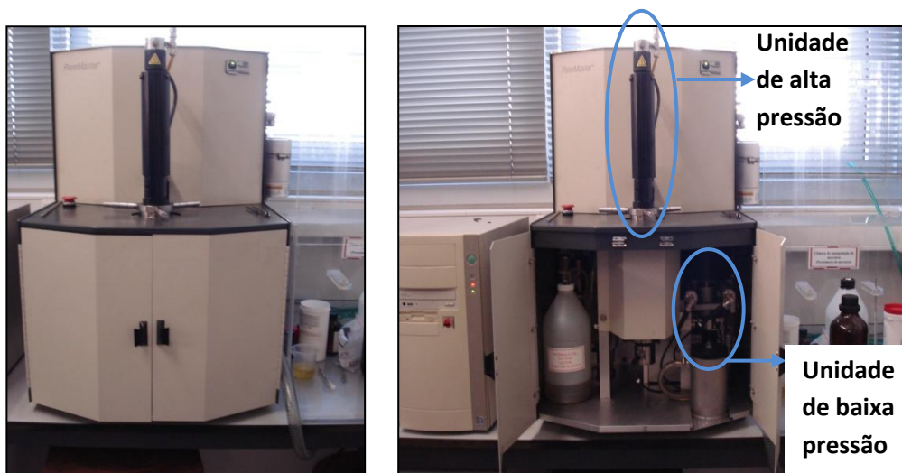
Figura 15: Porosímetro de mercúrio utilizado para determinação da massa volúmica aparente.
