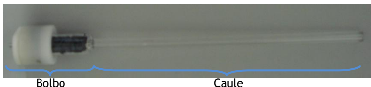
Figura 14: Fotografia do penetrómetro utilizado, com a amostra no bolbo.
