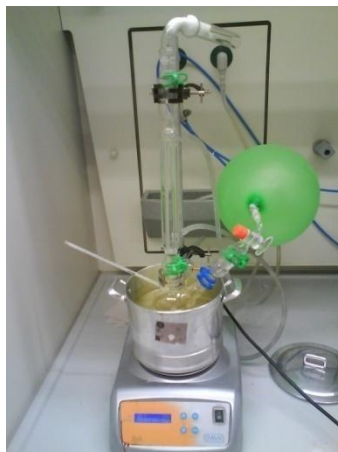
Figura 3.2 Instalação experimental da síntese do Polímero X.
