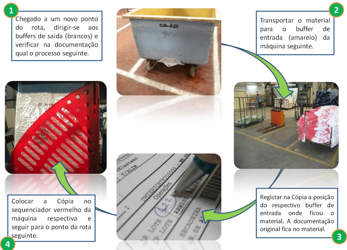
Figura 60. Ciclo de funcionamento do mizusumashi de material
