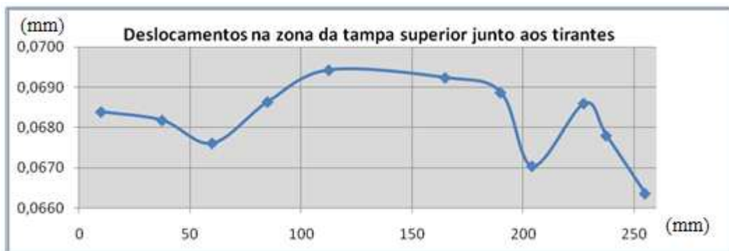
Gráfico 10-Valores do deslocamento na zona da tampa superior em contacto com os tirantes e corpo do cilindro.
