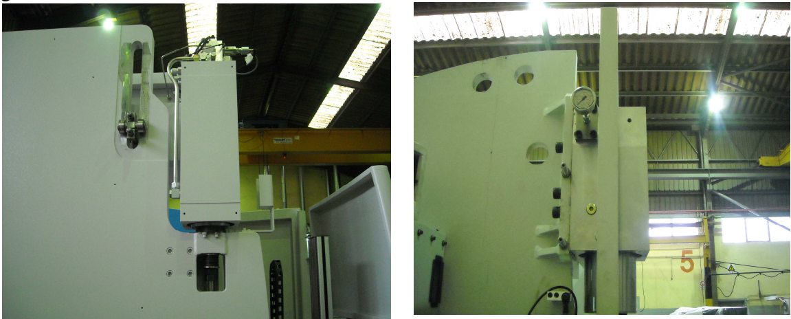
Figura 16- Vista frontal e lateral da montagem do cilindro numa quinadora
