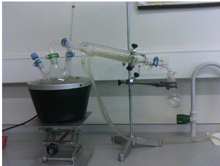
Figura 8 - Montagem de destilação utilizada na determinação do teor alcoólico das amostras.
