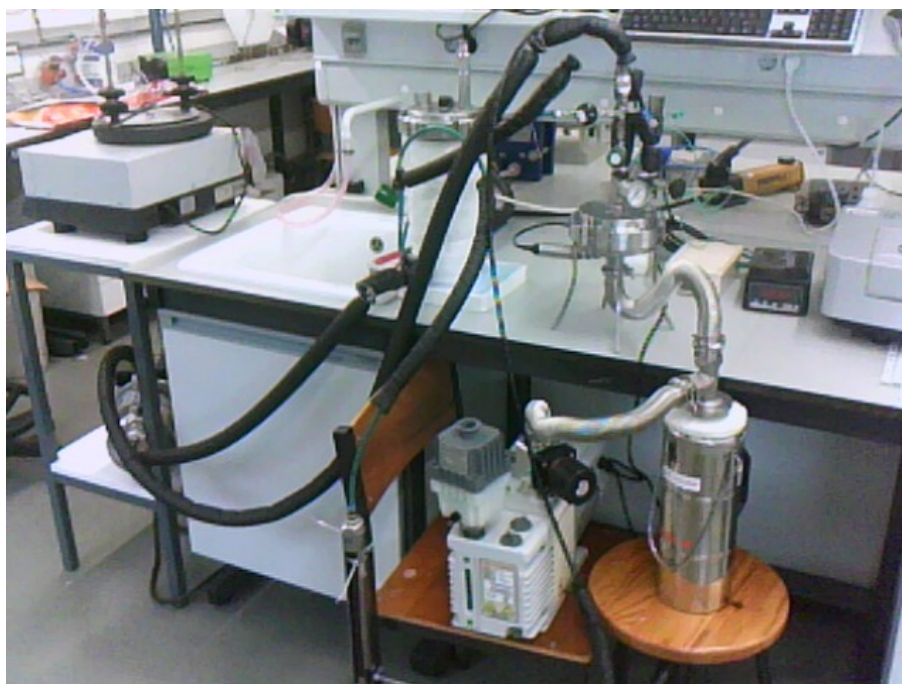
Figura 5 - Fotografia da instalação experimental utilizada nos ensaios de pervaporação.
