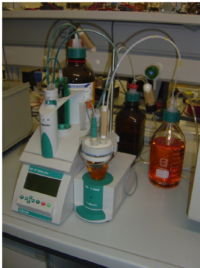
Figura 9 - Titulador usado na determinação da percentagem de água nos produtos obtidos.
