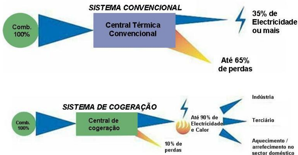
Gráfico 13: Esquema de um sistema de cogeração
