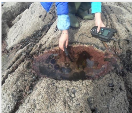
Fig.36 e 37. Método de medição da salinidade para calcular o volume da poça. Esquerda: Medição da salinidade inicial com o condutivímetro. Direita: extração de certo volume de água salgada e reposição pelo mesmo volume de água doce para mudar a salinidade e voltar a medir posteriormente.
