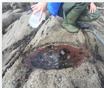
Fig.36 e 37. Método de medição da salinidade para calcular o volume da poça. Esquerda: Medição da salinidade inicial com o condutivímetro. Direita: extração de certo volume de água salgada e reposição pelo mesmo volume de água doce para mudar a salinidade e voltar a medir posteriormente.
