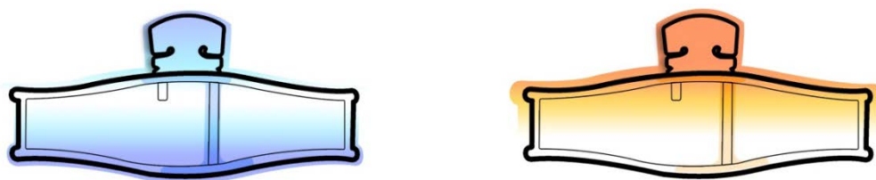
Figura 7 – Secção de corte de um violino. À esquerda, as vibrações são transmitidas primeiramente para as costas. À direita, as vibrações são transmitidas primeiramente para o tampo.
