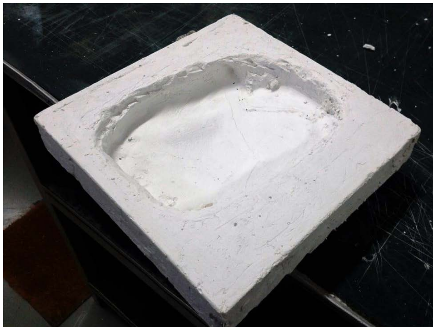
Figura 37 – Molde final em gesso.
