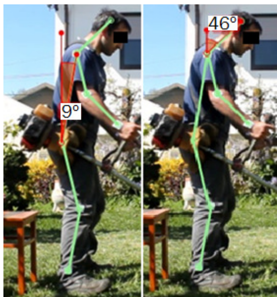
Figura 30 – Leitura das flexões absolutas do tronco e do pescoço
