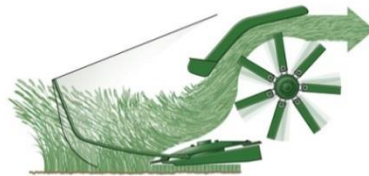
Figura 24. Gadanheira condicionadora de arrasto lateral a ceifar erva, formando cordões (esq.) e funcionamento das lâminas com sistema de propulsão condicionada da erva
