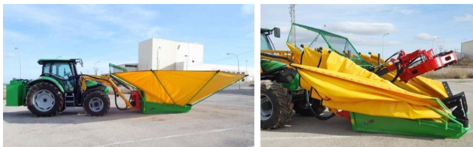
Figura 21. Recolector frontal Estupiña de 2011 com vibrador e tela extensível para apanha de azeitona e frutos secos
