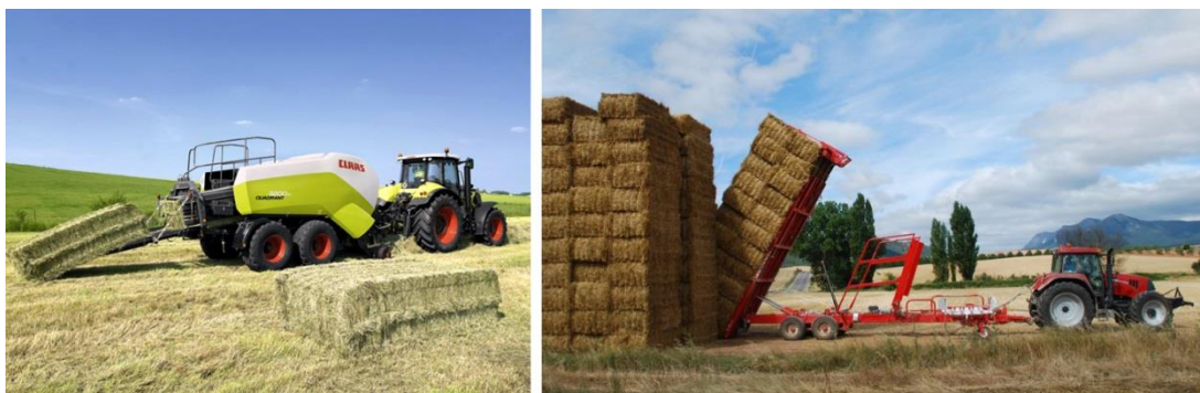
Figura 36. Fardos paralelepípedicos: Enfardadora Claas de 2012 (esq.) e transporte/arrumação (dir.)
