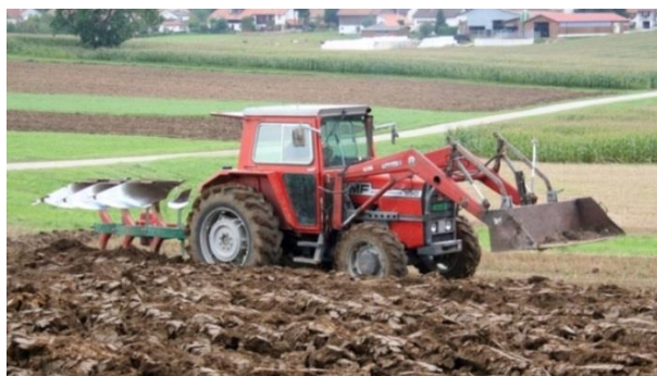
Figura 13. Trator com alfaia traseira (arado) e dianteira (carregador frontal)
