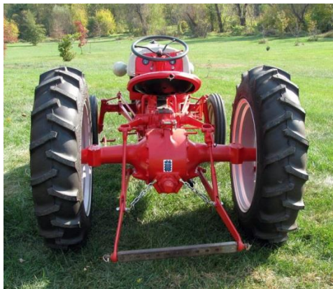
Figura 9. Ford N (1939-1954), o primeiro modelo Ford com sistema hidráulico de engate de três pontos (dir.)
