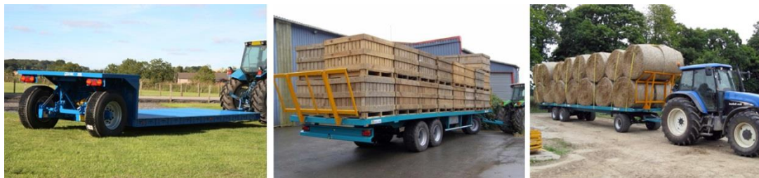
Figura 59. Semirreboques de plataforma: Marshall rebaixado 8t CCU (esq.); Rolland 20t CCU (centro e dir.)
