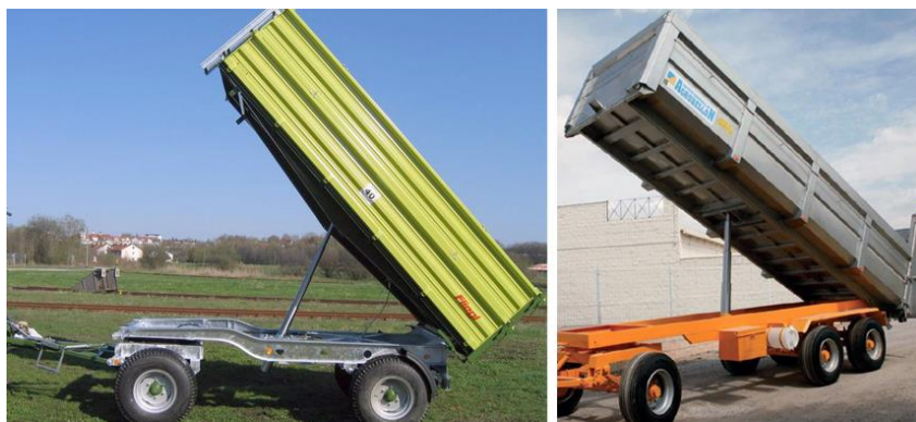
Figura 62. Semirreboque de taipal com chassis em aço galvanizado Fliegl 9.2t / 10 m 3 CCU (esq.); reboque Agribellon com caixa em aço-inoxidável 18t / 30 m 3 CCU (dir.)
