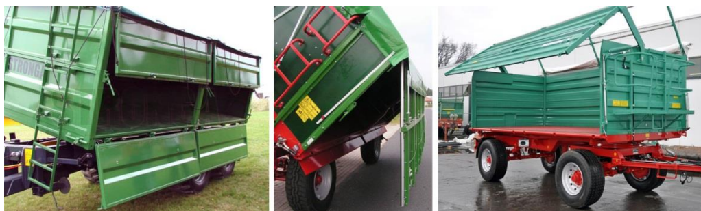
Figura 51. Abertura de taipais laterais (esq. para dir.): Stronga 24t/26 m 3 ; Pronar 13t/19.5 m 3 ; Farmtech 13.3t / 17 m 3
