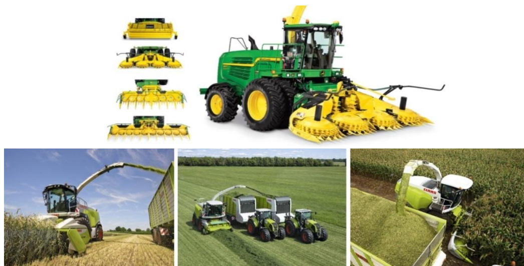
Figura 30. Em cima ensiladora de 2012 John Deere com cabeça de milho e quatro cabeças: erva/feno (superior) e milho (três inferiores). Em baixo ensiladora Claas de 2012 com três cabeças diferentes: cortador de erva (esq.), erva cortada (meio) e milho (dir.)
