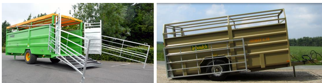
Figura 58. Semirreboque para transporte animal: Joskin com rampa (esq.); Le Boulch com sistema hidráulico de inclinação para facilitar entrada/saída dos animais (dir.)
