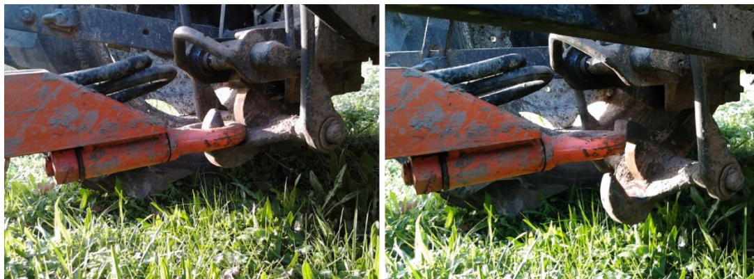
Figura 90. União do trator com o RA, através da subida do gancho do trator e engate na argola do RA.
