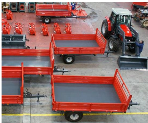
Figura 88. Linha de montagem de reboques de taipal na fábrica da Herculano
