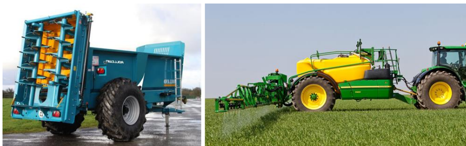
Figura 17. Reboque espalhador de estrume Rolland (esq.); reboque pulverizador de pesticidas ou fertilizantes John Deere (dir.)
