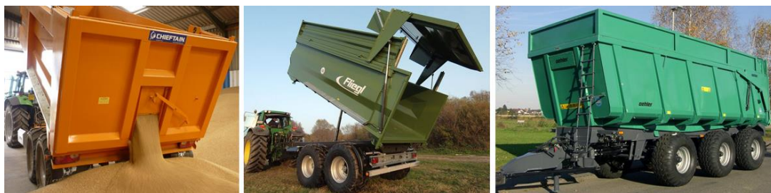
Figura 53. Semirreboque monocoque: Chieftain com boquete para cereal (esq.); Fliegl 12t / 13.7 m 3 CCU (centro); Oehler 25t / 24 m 3 CCU (dir.)
