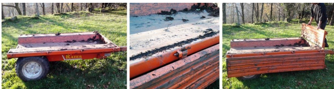
Figura 93. Montagem dos taipais na caixa
