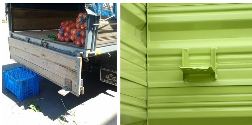
Figura 94. Degrau pivotante para auxílio de subida para a caixa, no exterior (esq.) e interior (dir.)
