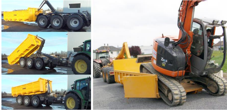
Figura 65. Sistema modular de braço hidráulico: Montagem da caixa Stronga (esq.); Transporte de veículos de construção civil em modelo Rolland (dir.)
