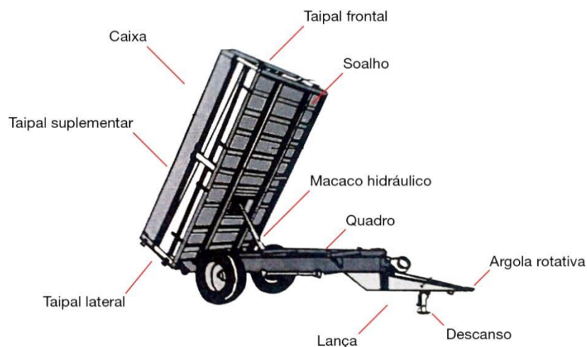
Figura 47. Composição de reboque agrícola de taipais
