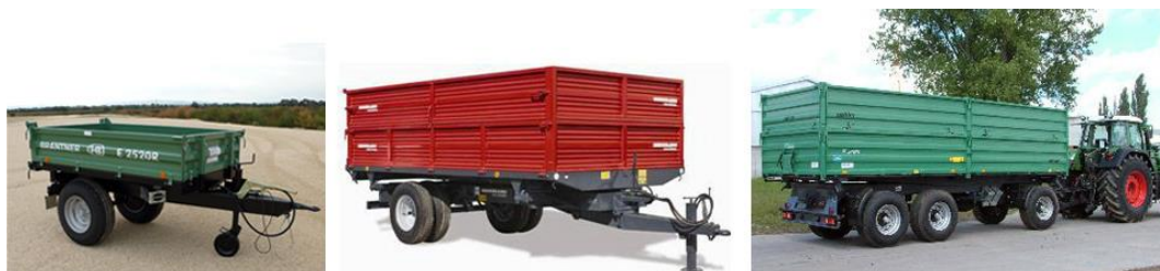
Figura 50. Semirreboque basculante Brantner com um eixo e 1,9t / 1 m 3 CCU (esq.); semirreboque Herculano de um eixo e 10t / 12 m 3 CCU (centro); reboque Oehler com três eixos e 17,5t / 27,5 m 3 CCU (dir.)
