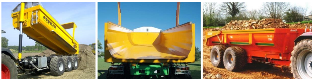
Figura 55. Semirreboque monocoque de construção civil: Joskin 27t / 13.9 m 3 CCU (esq. e centro); Jeantil 22t / 11.6 m 3 (dir.)
