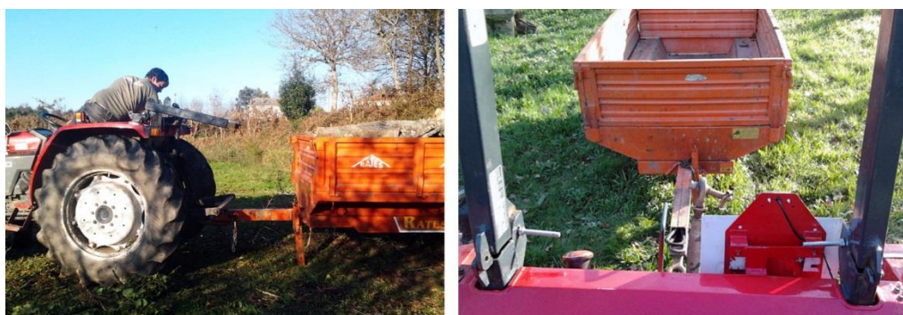
Figura 91. Dificuldade na visibilidade sobre a zona de união
