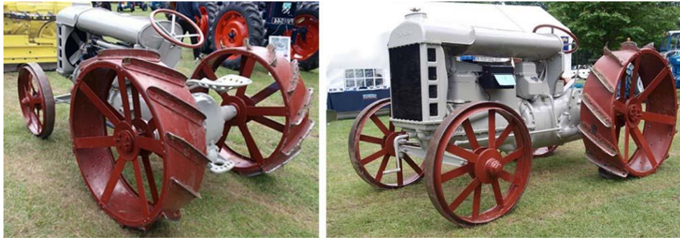
Figura 8. Trator Fordson F (1917-1928) o primeiro trator compacto a gasolina
