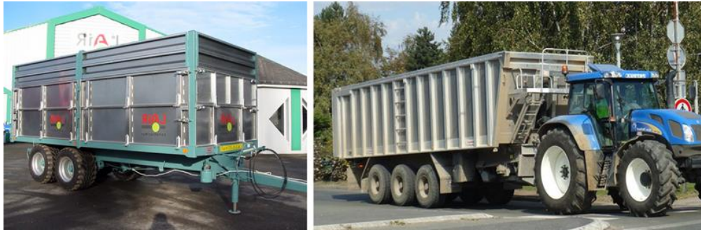
Figura 61. Semirreboque Lair 17t e 24 m 3 CCU com quadro em aço e taipais em alumínio (esq.); Benalu 26t e 38 m 3 CCU, totalmente construído em alumínio (dir.)
