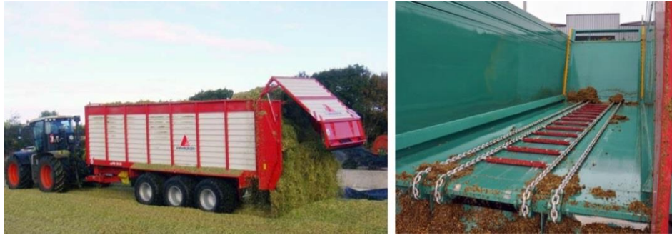
Figura 56. Semirreboque para silagem: Annaburger 24t/55 m 3 ; Interior de caixa com tapete deslizante e parede móvel para descarga Farmtech
