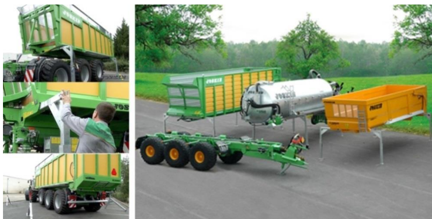
Figura 66. Sistema de caixa fixa Joskin : montagem de caixa para silo (esq.) e família de caixas disponíveis, silo, cisterna e monocoque (dir.)
