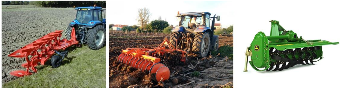
Figura 16. Diferentes tipos de alfaías para preparação de solo (esq. para dir.): Arado, grade de discos e fresa
