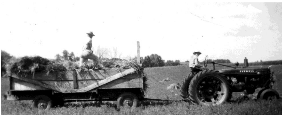
Figura 45. Reboque agrícola de aprox. 1945, com pneus, taipais de madeira, chassi e rodas de aço
