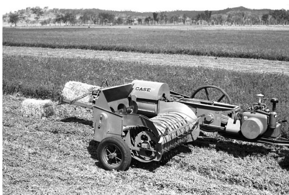
Figura 34. Enfardadora de fardos paralelepipedicos Case de 1953: Recolha, extrusão e aplicação de arame no fardo sem intervenção humana
