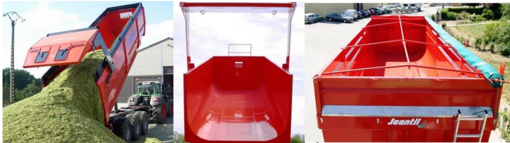
Figura 54. Semirreboque monocoque: Record 24t/32 m 3 CCU com taipal suplementar a descarregar silagem (esq.); Jeantil 14.8t / 12 m 3 CCU com cobertura (centro e dir.)
