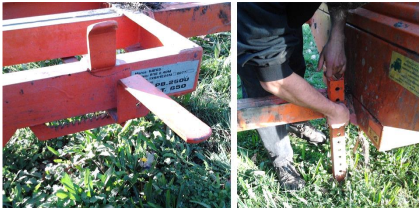
Figura 92. Travão de segurança (esq.) e descanso manual (dir.)
