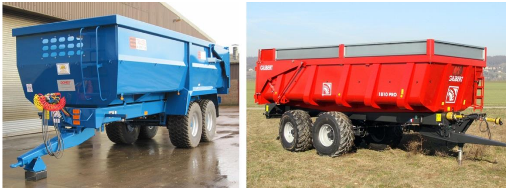
Figura 63. Comparação entre dois reboques monocoque (esq. para dir.): Modelo da fabricante inglesa Marston em aço de alta resistência Domex com 18t/23.4 m 3 CCU e 6700 kg de tara; Modelo da fabricante francesa Gilibert com 17.3t/21.3 m 3 e 6400 kg de tara.
