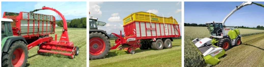
Figura 28. Recolha de forragem (esq. para dir.): alfaia, autocarregadora e ensiladora automotriz
