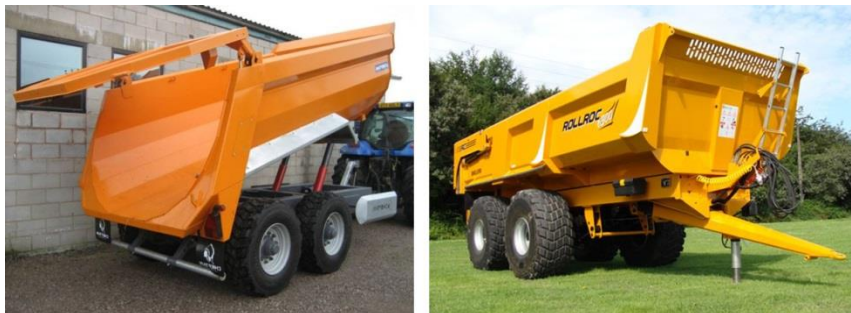
Figura 64. Comparação entre dois reboques monocoque de construção civil (esq. para dir.): Modelo da fabricante inglesa Cheftain em aço de alta resistência Hardox com 25t / 13.5 m 3 CCU com 5000kg de tara; Modelo da fabricante francesa Rolland em aço convencional com 21t/13.7 m 3 e 8000kg de tara.
