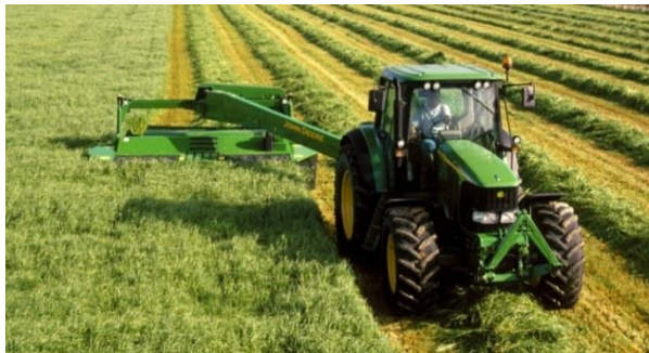
Figura 24. Gadanheira condicionadora de arrasto lateral a ceifar erva, formando cordões (esq.) e funcionamento das lâminas com sistema de propulsão condicionada da erva
