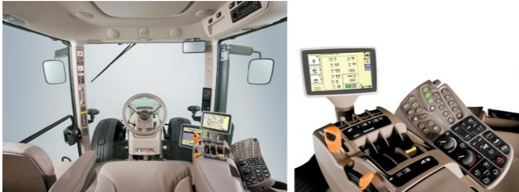
Figura 12. Interior de um trator John Deere 8r de 2012, (esq.) e comandos com ecrã para monitorização por GPS (dir.)
