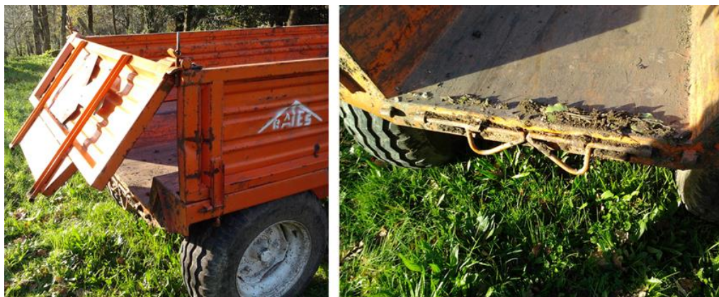
Figura 99. Abertura do taipal traseiro para descarga (dir.) e sujidade acumulada nos manípulos horizontais de abertura do taipal traseiro
