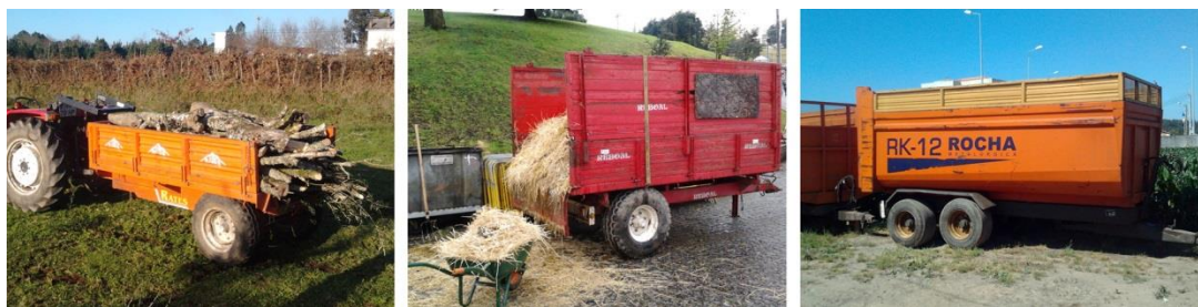
Figura 89. RA com visita de utilizador (esq. para dir.): Modelo Rates com caixa e taipais de aço, 1.85 t CCU, carga de madeira; Modelo Reboal com caixa de aço e taipais de madeira, 2.5t CCU, carga de feno; Modelo monocoque Rocha com caixa de aço, taipal suplementar de aço, 12t / 21 m 3 CCU, para carga de silo e estrume.
