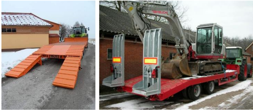
Figura 60. Semirreboques para transporte de veículos: Pronar 14.7 t CCU (esq.); Chieftain 15.8t CCU (dir.)
