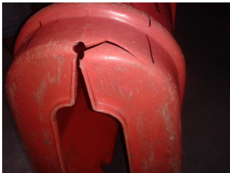
Figura 19 – Aspecto final do protetor após o ensaio de verificação.
