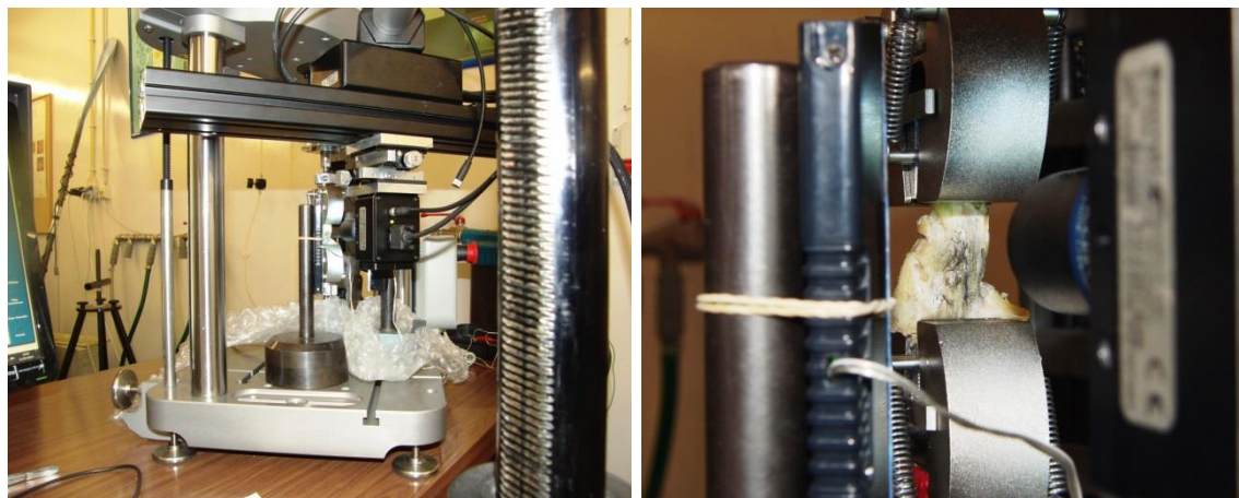
Figura 95 – Aplicação do toner no LCA e montagem do equipamento de correlação digital de imagem
