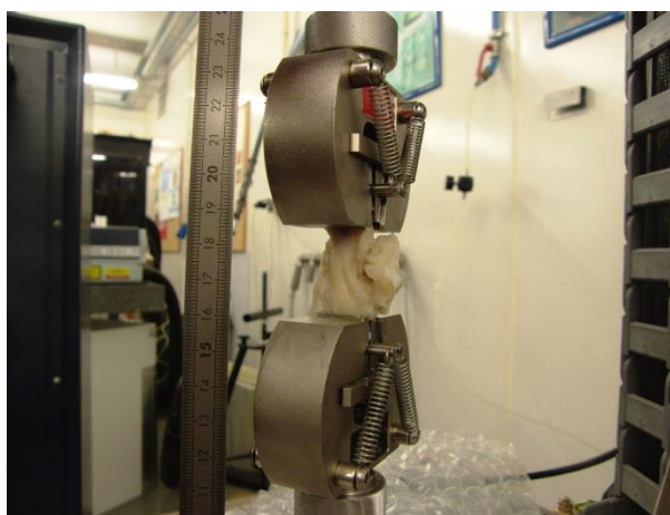
Figura 94 – Amarração do ligamento à máquina universal
