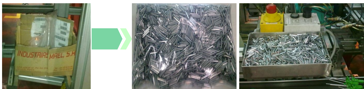
Figura 29: Embalagem de terminais de cabo 'antes' e 'depois' respetivamente. Bordo de linha aplicado.
