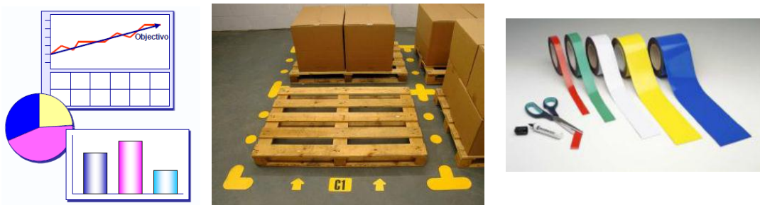
Figura 11: Exemplos Gestão Visual: gráficos, marcas no chão e fita para marcar o chão.
