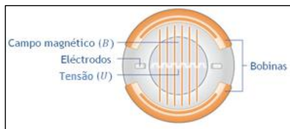
Figura 3.8 - Funcionamento de um Caudalímetro Electromagnético (CE) (Fonte: KROHNE).
