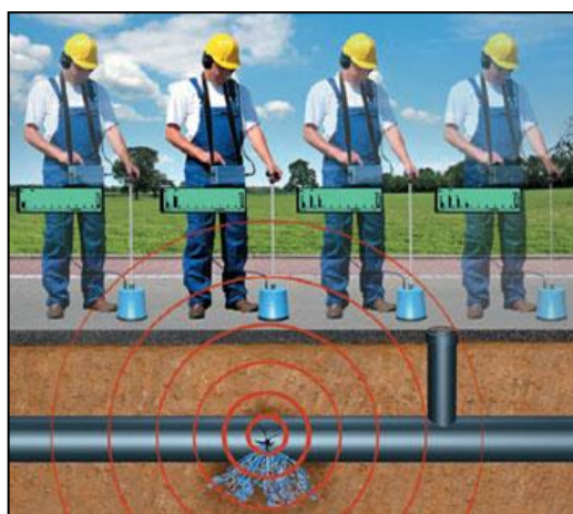
Figura 2.8 - Utilização de geofone para a detecção acústica de fugas (Fonte: SONDEQ).
