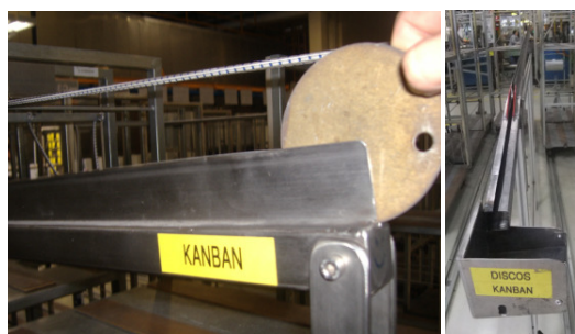
Figura 21 Rampa de Discos Kanban
