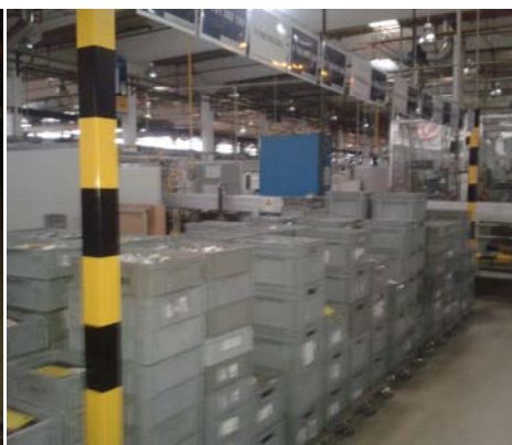
Figura 29 Supermercado com guias, carros e identificações por referência
