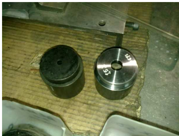
Figura 17 – Fieira no estado inicial e fieira rectificada após tratamento e registo
