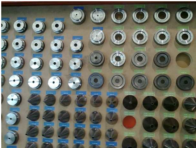
a) Disposição das fieiras e guia-fios com cada lugar devidamente etiquetado
