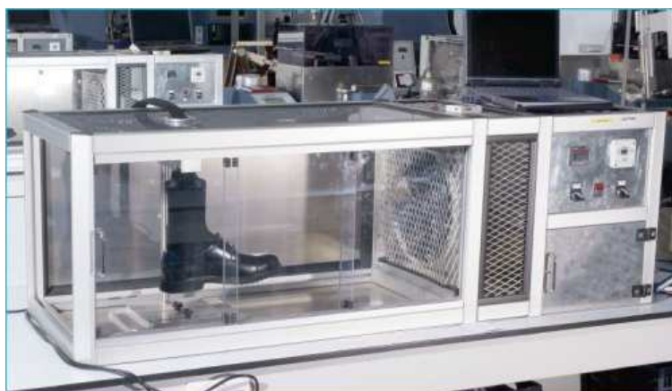
Figura 3: Equipamento para avaliar o desempenho térmico e a gestão de humidade no calçado (AMMT)
