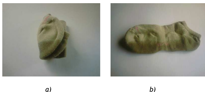
Figura 21: Meia molhada na zona que fica em contacto com a rede, a) meia dobrada e b) meia na posição normal
