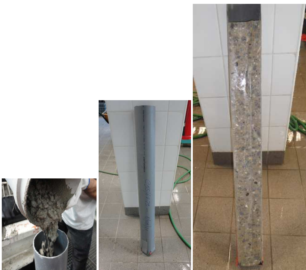
Figura 4.8 – Execução do ensaio para verificar a existência de segregação
