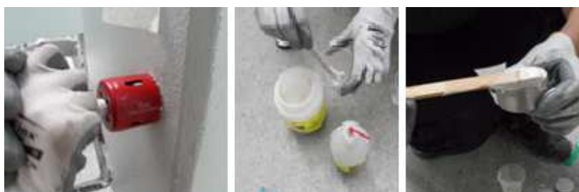
Figura 3.50 – Corte da camada a ensaiar; Mistura do endurecedor e da cola; aplicação da resina na peça
