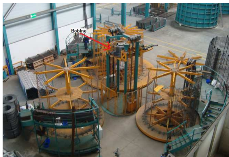
Figura 3.12 – Máquinas de moldagem da armadura longitudinal para os segmentos
