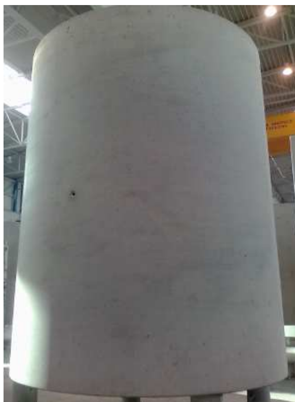
Figura 4.13 – Segmento18 betonado com BAC
