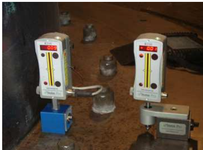
Figura 3.41 – Verificação da planura na base do molde
