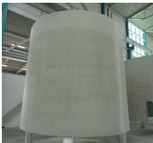
Figura 3.45 – Segmento pronto para aplicação do revestimento
