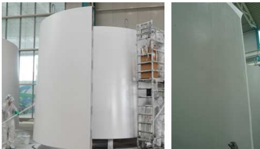
Figura 3.46 – Aplicação da resina do lado esquerdo e da tela no lado direito
