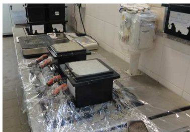
Figura 3.29 – Moldagem dos provetes de betão com dimensões 150x150x150mm
