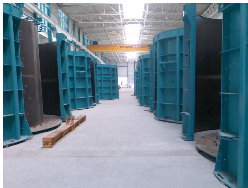
Figura 3.16 – Moldes para a betonagem
