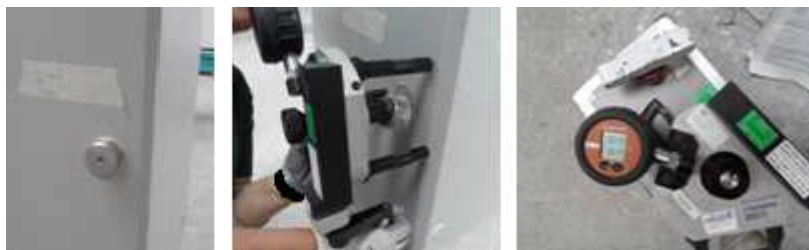
Figura 3.51 – Fixação da pastilha no segmento; Aplicação do equipamento de ensaio; registo do valor obtido
