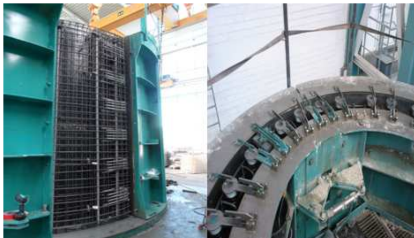
Figura 3.18 – Fase final da preparação dos moldes
