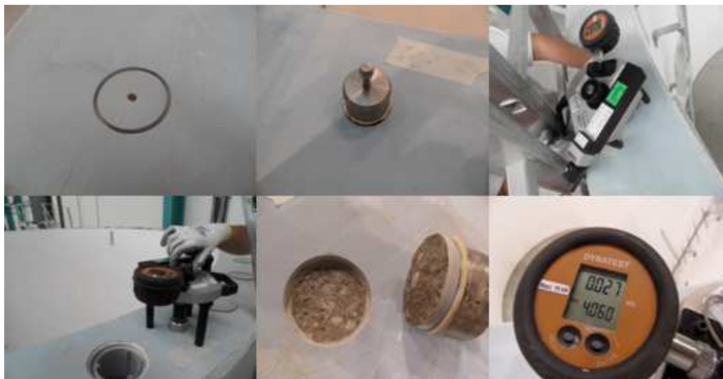
Figura 3.44 – Exemplo de execução do ensaio pull-off da resina
