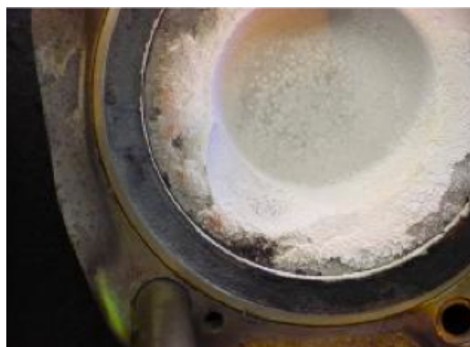
Figura 7 - Siloxanos depositados num motor de combustão (retirado de [17])
