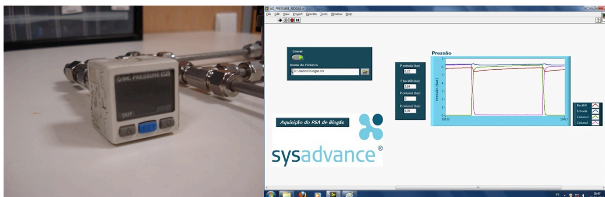
Figura 14 - Sensor de Pressão (esquerda) e programa de aquisição de pressões em LabView (direita).
