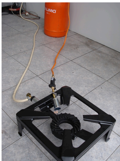
Figura 12 - Queimador e chama-piloto
