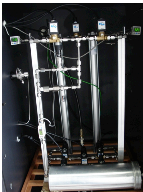
Figura 10 - Unidade experimental de purificação de biogás.
