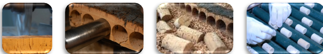
Figura 5: Produção de rolhas de cortiça natural. Da esquerda para a direita: rabaneação 1 ; brocagem; rabanada de cortiça brocada para produção de rolhas naturais; rigoroso controlo de qualidade.
