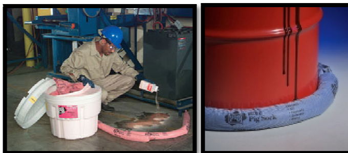
Fig.16 – granulado e “socks” em acção em ambiente industrial
