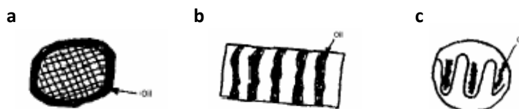
Fig.12 – (a) Adsorção – o óleo adere à superfície do material.
