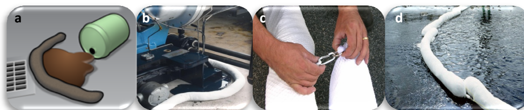
Fig.17 – Contenção: (a) e (b) – “socks”; (c) e (d) – “booms”
