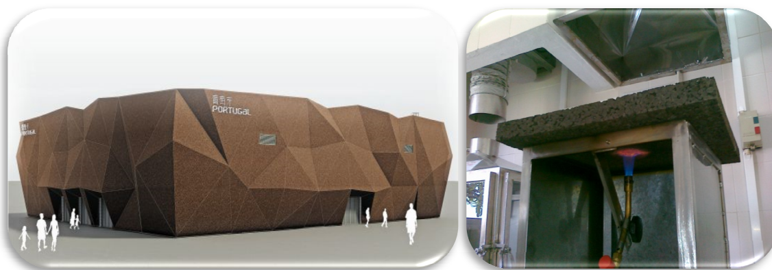
Figura 49 – Isolamentos: (a) – Exterior do pavilhão de Portugal na Expo Xangai 2010; (b) – placa de isolamento submetida a chama de 700°C
