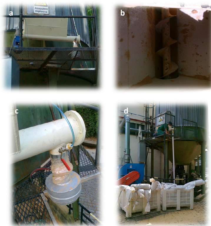
Fig.39 – Processo actual: (a) novo equipamento de enchimento; (b) sem-fim; (c) sistema de acoplamento; (d) processo mais seguro e eficiente
