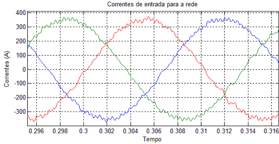
Figura 5.4 - Forma de onda de corrente de entrada para a rede.
