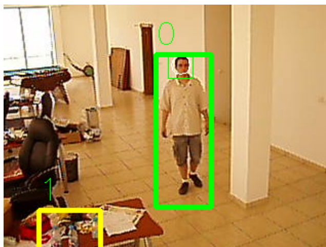
Figura 45 - Resultado final da implementação onde detectou um objecto em movimento em cima da secretária.
