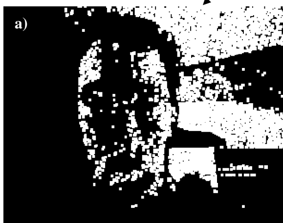
Figura 30 – Resultados finais da aplicação de dois métodos de análise de cor: a) Imagem resultante da primeira abordagem (utilização da escala HSV); b) Imagem resultante da segunda abordagem (utilização da escala RGB).
