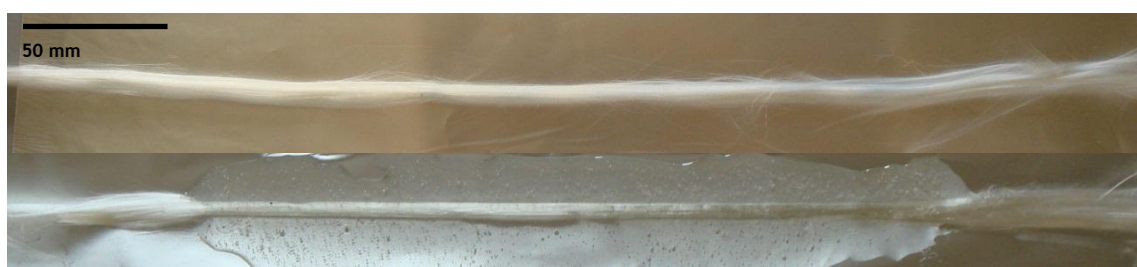
Figura 66 - Imagem dos espécimes de PBG preparados para tracção.
