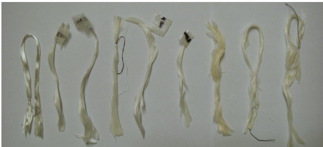
Referência 1ºEstágio 3º Estágio 4ºEstágio 5ºEstágio 6ºEstágio 7ºEstágio 8ºEstágio 9ºEstágio Figura 74 - Aspecto dos espécimes de PBG sem degradação (amostra de referência) e ao longo de 8 estágios de degradação.
