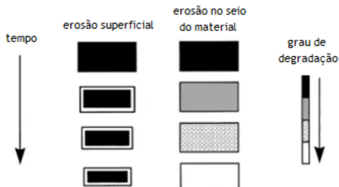
Figura 22 - Ilustração esquemática das alterações a nível matricial causadas por erosão superficial e erosão no seio do material. Adaptada de [73]
