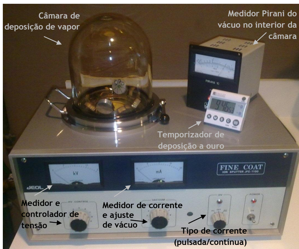
Figura 69 - Fotografia do equipamento utilizado para aplicar um revestimento de ouro nas amostras a observar em SEM (Joel Fine Coat Ion Sputter JFC - 1100).
