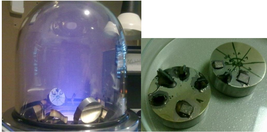
Figura 70 - Imagem do plasma formado dentro da câmara de deposição e pormenor do revestimento final em ouro das amostras fixadas previamente no porta-amostras.
