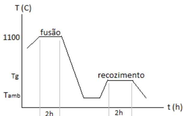
Figura 12 - Gradiente térmico existente no processamento do PBG quaternário (P_2O_5)_{45} - (CaO)_{25} - (Na_2O)_{70-z} - (TiO_2)_z , para z variável de 0 a 2,5%mol.
