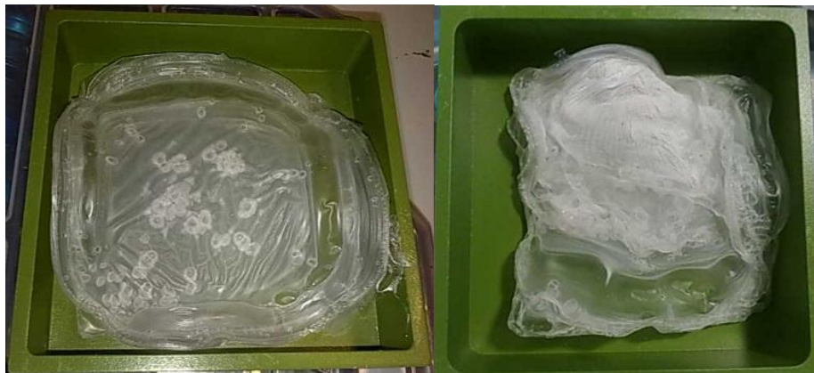
Figura 60 - Placas de PLA deformadas pela utilização inadequada do vácuo na sua produção.
