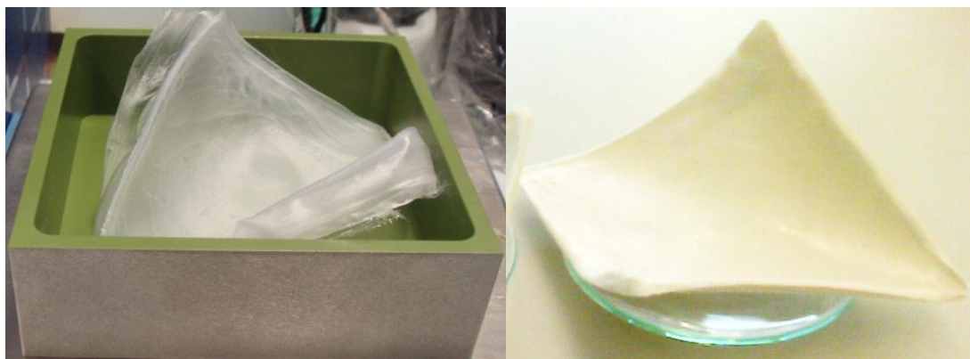
Figura 63 - Placas de PLA e PLA/PBG obtidas pelo procedimento de solvent casting .
