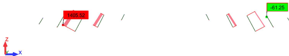
Figura 5.42 – Envoltória de esforços transversos segundo z dos montantes sobre os arcos para o estado limite último (STR)
