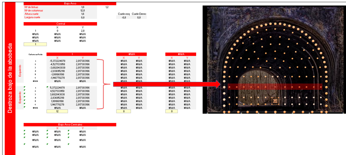
Figura 7-22 - Cálculo de los barrenos localizados entre los barrenos de la destroza superior y el cuele
