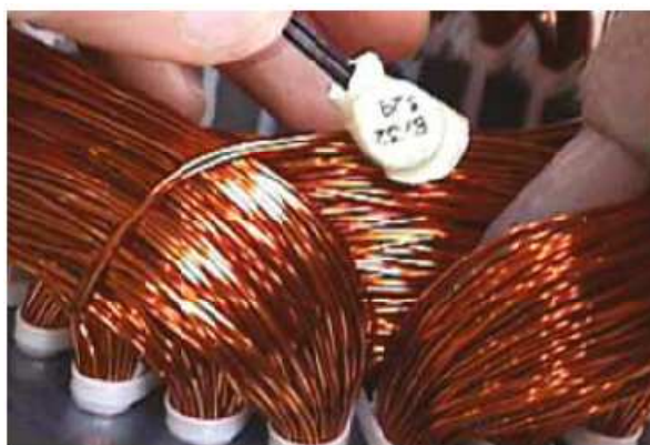
Figura 4.16 – Instalação dum termóstato numa bobinagem [5]
